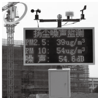
图9-7 施工现场扬尘噪声监测
